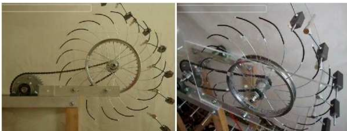
Фиг.6. Вариант двигателя М.Ф.Дмитриева, в котором смещение грузов вправо в правом верхнем квадранте осуществляется принудительно с помощью дополнительного колеса, энергия для вращения которого берется с основного вала.
