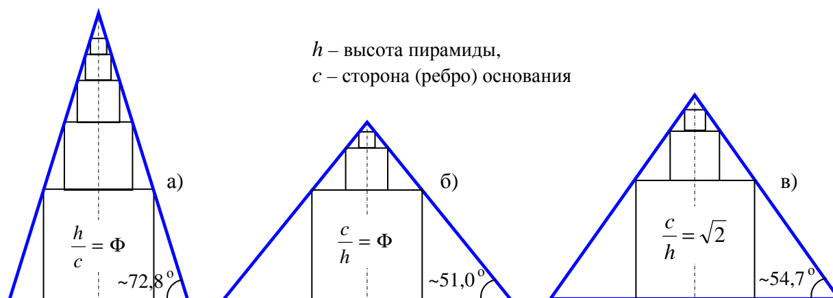
Рис. 3. Система вписанных кубов в правильную четырёхгранную пирамиду (сечение проведено через противоположные апофемы)
